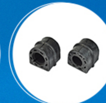
Freio: Kit buchas estabilizador dianteiro (furo 23mm) Cód: 10861
